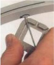
A l'aide de la clé à rayons, retendez les rayons opposés au côté voilé et détendez ceux côté voile, en effet les rayons partent alternativement vers la gauche ou la droite du moyeu.
